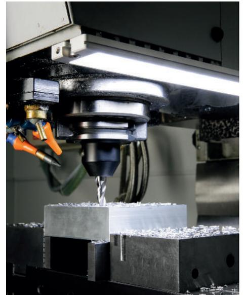
Die Maschinenbeleuchtungen der Serie MB zeichnen sich durch Ihre robuste Bauweise und ihren hervorragenden technischen Eigenschaften aus. Die aussergewöhnlich hohe Anzahl der verbauten LEDs erzeugen eine homogene Lichtausbeute bei 156 Lumen/Watt, verhindern aber gleichzeitig einen Mehrfachschatten. Der PWM Eingang ermöglicht das dimmen und schalten der Lampe.
